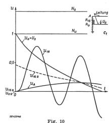
Berechnete Spannungen  $u_{16}$  und  $u_A$  gegen Erde der Wicklungspunkte A und  $u_{16}$  bei einem Stoss  $U_S$  auf unterste Regulierstellung
