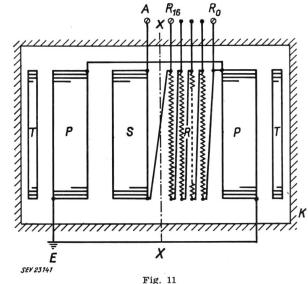
Eisenfenster des Regulierspartransformators mit Regulierwicklung in Lagenanordnung mit 16 Stufen  $R_0...R_{16}$
