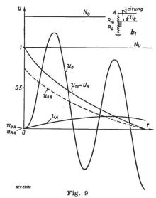
Berechnete Spannungen  $u_A$  und  $u_0$  gegen Erde der Wicklungspunkte A, und  $R_{10}$  bei einem Stoss  $U_S$  auf die oberste Regulierstellung
