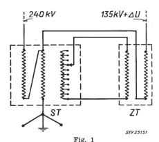
Spar- und Zusatztransformator mit Regulierung der Unterspannung
