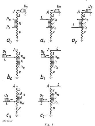
nungsseitig an eine Leitung oder Sammelschiene angeschlossen. Bei den Stoßschaltungen  $a_1$  und  $a_2$  fällt die Stoßspannung von der Oberspannungsleitung auf die Oberspannungsklemme A des Transformators, während an die Klemme  $R_{16}$  beziehungsweise  $R_0$  die Unterspannungsleitung angeschlossen ist. Bei der Stoßschaltung  $b_1$  fällt die Stoßspannung
