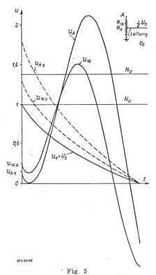
Berechnete Spannungen gegen Erde der Wicklungspunkte A und  $R_{16}$  bei einem Stoss  $U_S$  auf die Unterspannungsleitung Tiefste Regulierstellung; Transformator von der Oberspan-nungsleitung abgetrennt
