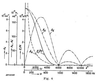
Weg-, Geschwindigkeits- und Beschleungungsamplitude, sowie spezifische Schwingungsenergie in Abhängigkeit von Eigenkreisfrequenz  $\omega$  und Eigenfrequenz  $\nu$  nach Beispiel 1
