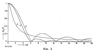
Dimensionslos aufgetragenes Spektrum der Geschwindigkeitsamplituden der Beispiele 1...3
