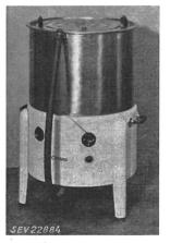
Machine à laver, selon figure, avec chauffage. Barreau chauffant disposé au fond de la cuve à linge en acier inoxydable. Agitateur tournant alternativement dans un sens et dans l'autre. Entraînement par moteur triphasé, ventilé, à induit en court-circuit. Interrupteurs, modèle pour locaux mouillés, pour chauffage et moteur. Lampe témoin à effluve. Cordon de raccordement à quatre conducteurs, fixé à la machine.
