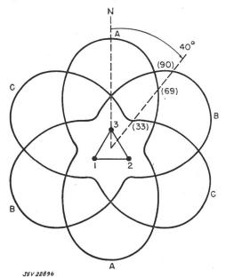
Fig. 1 Navaglobe-Ausbreitungs-Charakteristik
