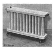
des fers plats, recouverts de tôle en bas et en haut. Commutateur à trois allures de chauffe, encastré. Fiche d'appareil encastrée pour le raccordement de l'amenée de courant. Poignées en matière isolante.
