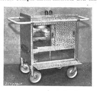
de chauffe à isolation au mica et gaine de tôle, logés verticalement au centre de la servante. Thermostat avec positions de réglage et lampe témoin. Bâti à double paroi en métal léger avec calorifugeage. Poignées isolées. Cordon de raccordement à trois conducteurs isolés au caoutchouc, fixé à une boîte de raccordement.
