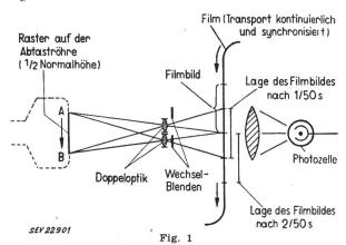
Filmübertragung durch Punktlichtabtastung bei kontinuierlich laufendem Film für Fernsehsysteme mit 50 Hz Vertikalfrequenz, wobei der Filmvorschub teilweise zur Erzeugung der Vertikalabtastung mithilft
