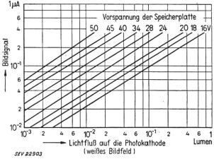
Fig. 3 Übertragungskennlinien des Vidicons Typ 6326 (RCA)
