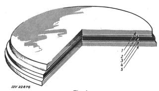
Fig. 1 Gleichrichterelement des Semitrons
