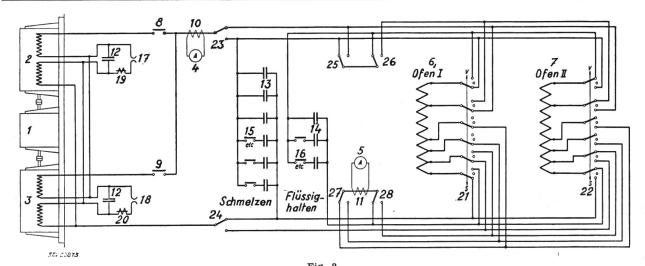
Fig. 2 Vereinfachtes Schema der Induktionsofenanlage Kilsta der AB Bofors
