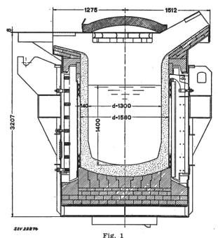
12-t-Induktionsofen der ASEA, Längsschnitt Masse in mm
