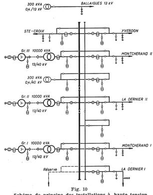
Schéma de principe des installations à haute tension
