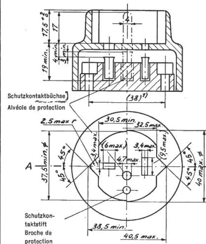
Der Stecker ist so auszuführen, dass der einsetzbare Schutzkontaktestift mit der Schutzkontaktebüchse unabhängig vom Anschluss des Schutzleiters so verbunden werden kann, dass er in seiner Lage festgehalten ist und sich nicht lockern und nur mit Werkzeugen gelöst werden kann. Kann der Schutzkontaktestift bei Nichtgebrauch nicht unverlierbar im Stecker untergebracht werden, so muss einer der beiden Schutzkontaktestifte I und II eingebaut werden können.
