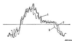
Fig. 5 Stromverlauf bei Prüfung eines Transformators 11 000 kVA, 63 kV  $\pm$  19 % / 46 kV—15,333 kV, Ydll, mit abgeschnittener Stoßspannung
