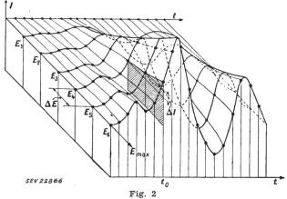
Axonometrische Darstellung der Funktion  $I = f(t, E_m)$  und der Kurven I = f(t) für verschiedene Werte von  $E_m$
