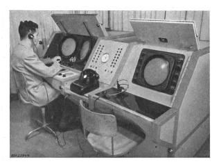
Fig. 3 Radar-Arbeitspulte für den Schlechtwetter-Anflug Rechts der Anzeigeschirm des Überwachungsradars, links der Azimut- und Elevationsanzeigeschirm des Präzisions-Landeradars. In der Mitte Wellenwähler für die Sprechverbindungen mit den Flugzeugen
