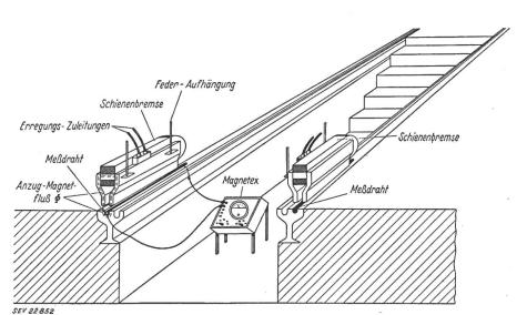
Fig. 2 Prüfstand in einer Wagenhalle zur Kontrolle der Anzugkraft der Schienenbremsen von Strassenbahnwagen
