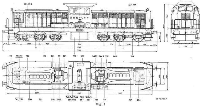
Dieselelektrische Lokomotive Bm 6/6 der SBB
