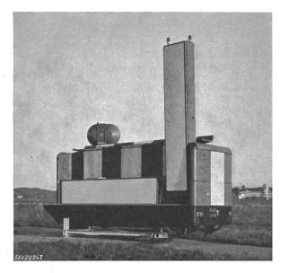
Fig. 2 Präzisionsradar-Wagen auf Drehgestell zur Bedienung der Blindlande- und Westpiste
