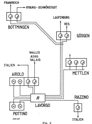
Exemple de réglage à l'intérieur d'un grand réseau (ATEL) R: régulateur de réseau
