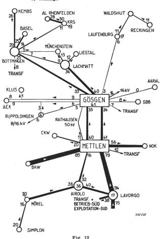
Fig. 12 Répartition de la charge réactive dans le réseau d'ATEL, mercredi, 16 juin 1954 à 11.30 h.
