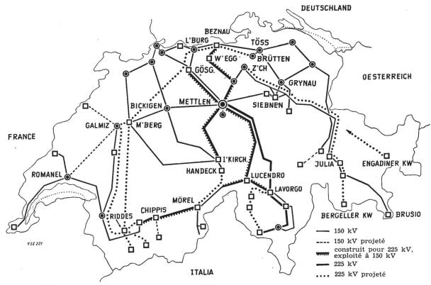
Fig. 1 Le réseau suisse à haute tension 150/225 kV.
