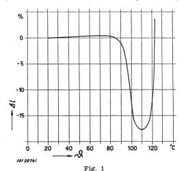
Längenänderung  $\Delta l$  von Polystyrolfilm in Funktion der Temperatur  $\mathfrak S$
