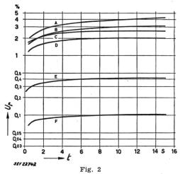
Restspannung  $U_r$  von Kondensatoren mit verschiedenen Dielektrika als Funktion der Zeit t nach Unterbruch des Kurzschlusses
