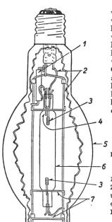
Im Prinzip ist die Betriebsweise dieser Lampe die gleiche wie bei den röhrenförmigen Fluoreszenzlampen: Einerseits werden die ultravioletten Strahlen durch den Leuchtstoff in Licht umgewandelt, anderseits wird ein Teil des von der Quecksilberentladung direkt ausgestrahlten Lichtes absorbiert, so dass das ausgesandte Licht die Zusammensetzung beider Lichtarten ist. Wie die meisten Entladungslampen
