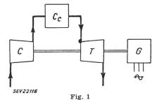
Einfachstes Schema einer Gasturbinenanlage C Kompressor;  $C_c$  Brennkammer; T Turbine; G Generator
