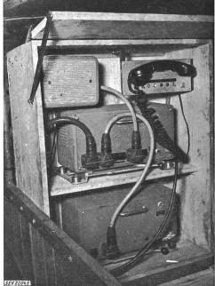
Fig. 5 Innenansicht der mobilen Station mit Lautsprecher
