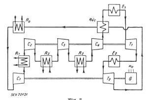
Fig. 7 Schema einer Gasturbinenanlage mit geschlossenem Kreislauf, mit zweifacher Zwischenkühlung und einfacher Zwischenerhitzung
