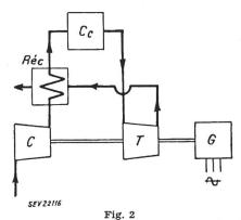
Schema einer Gasturbine mit Rekuperator Réc Rekuperator, Wärmeaustauscher Weitere Bezeichnungen siehe Fig. 1
