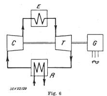
Schema einer Gasturbinenanlage mit geschlossenem Kreislauf
