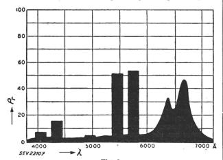
Fig. 2 Spektrale Energieverteilung der sichtbaren Strahlung einer Quecksilberlampe mit fluoreszierendem Kolben  $\lambda$  Wellenlänge in Ångström 1);  $P_r$  relative Energie
