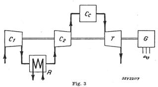
Schema einer Gasturbine mit einem Zwischenkühler
