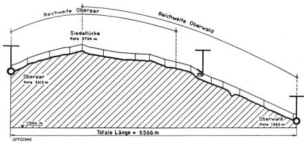
Fig. 2 Längenprofil Oberwald-Oberaar Anlage 2
