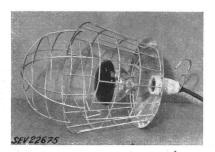
tôle avec douille en porcelaine E 27 et panier protecteur en fil de fer galvanisé. Diamètre maximum du panier protecteur 300 mm, hauteur jusqu'à l'écran 390 mm. Cordon d'appareil renforcé à deux conducteurs, avec fiche 2 P + T.
