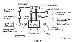
Prinzipschema der Regelung der Leistung (Neutronenfluss) einer Pile mit Sicherheitsvorrichtungen (Ausführungsbeispiel)
