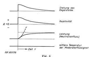
Schwerwasser-Reaktor mit indirekter Dampferzeugung Vorgänge bei einer durch Verstellen des Regelstabes hervorgerufenen Leistungsänderung (Moderatortemperatur leistungsunabhängig)
