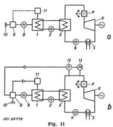
Prinzip-Regelschema eines Atomkraftwerkes a Mit selbstregelndem Reaktor, für frequenzabhängige Kraftwerkleistung b Mit nicht selbstregelndem Reaktor, für frequenzabhängige Kraftwerkleistung
