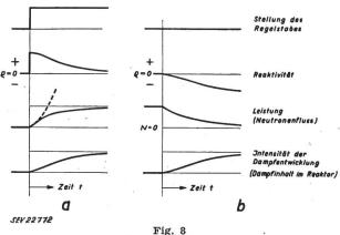
Schwerwasser-Reaktor mit direkter Dampferzeugung a Leistungsänderung durch Verstellung des Regelstabes b Leistungsänderung durch Druckschwankung
