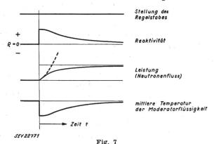
Schwerwasser-Reaktor mit indirekter Dampferzeugung Vorgänge bei einer durch Temperaturänderung der Moderatorflüssigkeit hervorgerufenen Leistungsänderung
