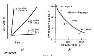
Fig. 4 Abhängigkeit des Verlaufes von Leistungsänderungen von der Grösse der Reaktivität Erläuterungen im Text
