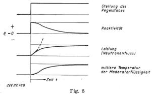
Schwerwasser-Reaktor mit indirekter Dampferzeugung Vorgänge bei einer durch Verstellen des Regelstabes hervorgerufenen Leistungsänderung (Moderatortemperatur leistungsabhängig)
