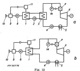
Prinzip-Regelschema eines Atomkraftwerkes
