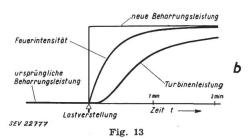
Leistungsverlauf nach plötzlicher Verstellung des Beharrungswertes der Feuerung a Atomkraftwerk mit indirekter Dampferzeugung; b Dampfkraftwerk
