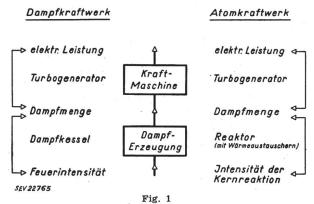
Vergleich der Grundaufgabe der Regelung im Dampf- und Atomkraftwerk
