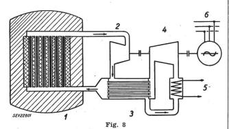
Schema einer Atom-Gasturbokraftanlage mit geschlossenem Helium-Kreislauf
