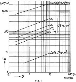
Wärmeübertragungseigenschaften U verschiedener Wärmeträger in Funktion der Dissipation D
