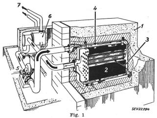
Heterogener Reaktor mit Graphitblock als Moderator 1 Strahlungsschutz; 2 Moderator; 3 Uranstäbe; 4 Wärmeträger-Kanäle; 5 Umwälzpumpe; 6 Wärmeaustauscher; 7 zur Kraftanlage
