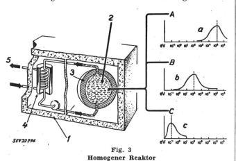
1 Strahlungsschutz; 2 umlaufende Flüssigkeit (Brennstoff in Lösungsmittel); 3 Reflektor; 4 Wärmeaustauscher; 5 zur Kraftanlage; A grosses Atomgewicht; B mittleres Atomgewicht; C kleines Atomgewicht; a schnelle Neutronen; b Resonanz-Neutronen; c thermische Neutronen
