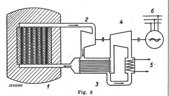
Schema einer Atom-Gasturbokraftanlage mit geschlossenem Helium-Kreislauf
