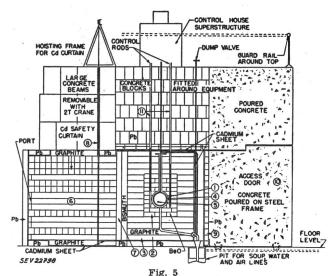
Homogene Breederreaktoranlage im Schnitt
