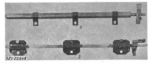
Fig. 4 Auslösewelle a alte Ausführung; b neue Ausführung
