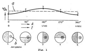
Wirkungsweise des photoelektrischen Abtasters  $\phi$  Lichtstrom; A Lage der Scheibe; t Zeit a Lichtstrom, wenn der Schwerpunkt der Abbildung mit dem Scheibenzentrum zusammenfällt; b Abbildung des Sterns
