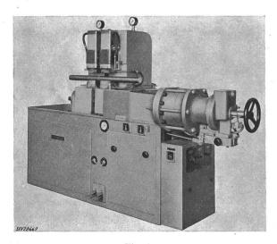
Fig. 12 Vollautomatische pneumatische Abbrenn-Stumpfschweissmaschine
