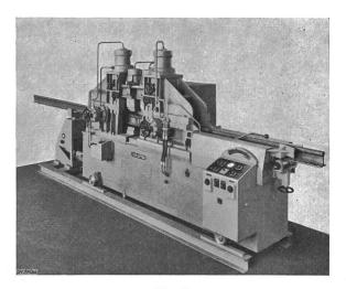
Fig. 11 Vollautomatische Stumpfschweissmaschine für Eisenbahnschienen
