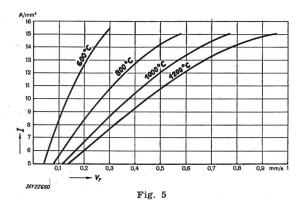
Fig. 5 zeigt die Abhängigkeit der Vorwärm-Endtemperatur, d. h. derjenigen Temperatur, bei welcher der kontinuierliche Abbrennprozess einsetzen kann, von der spezifischen Stromdichte im Werkstück und der relativen Annäherungsgeschwindigkeit  $v_r$  der Stückenden.
