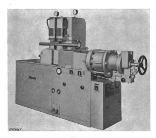
Fig. 12 Vollautomatische pneumatische Abbrenn-Stumpfschweissmaschine
