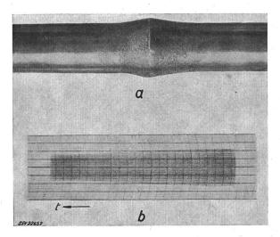
Fig. 2 Preßstumpfschweissung
