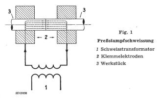
Stückenden zu einer soliden Verbindung, wobei die auf Weissglut erhitzten Materialpartien zu einer wulstförmigen Verdickung aufgestaucht werden.
