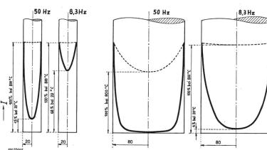
Fig. 10 Stromverdrängung in Flußstahl bei Abbrenn-Stumpfschweissung
