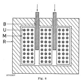
Schema eines Uran-Graphit-Reaktors
