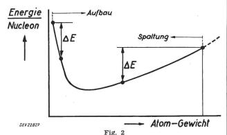
Mittlere Bindungsenergie E der Kerne (pro Nukleon) als Funktion des Atomgewichtes A
