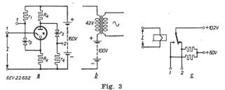
Wirkung der zwei möglichen Spannungsteiler
