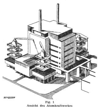
und die während der voraussichtlichen Lebensdauer der Anlage nicht geöffnet werden müssen. Kamine üblicher Art sind nicht erforderlich. Jedes Reaktorgebäude hat zwei verhältnismässig kleine Entlüfter, durch welche überschüssige Wärme abgeführt werden kann. In die Entlüfter sind Filter eingebaut, die verhüten sollen, dass radioaktive Staubteilchen aus dem Reaktor in die umgebende Luft gelangen können.
