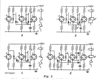
Einige Relaisschaltungen mit Kaltkathodenröhren Ob die Röhre I gezündet ist oder nicht, hängt vom Zustand der Röhren A und B (und evtl. C) ab, und zwar in gleicher Weise wie die Erregung des nebenstehend gezeichneten Relais I von der Stellung der Kontakte  $\alpha$  und  $\beta$  (sowie evtl.  $\gamma$ ) abhängig ist. Der Widerstandwert von R und R' ist sehr gross gegenüber dem Durchlasswiderstand der Gleichrichterelemente
