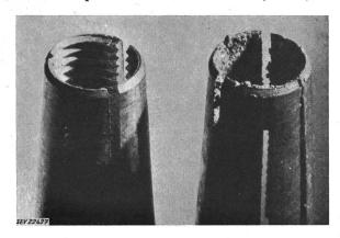
Fig. 5 Cônes du raccord défectueux (agrandissement)
