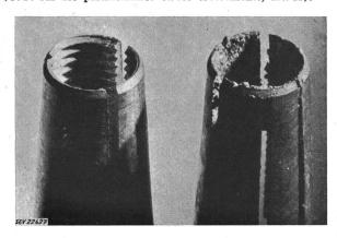
Fig. 5 Cônes du raccord défectueux (agrandissement)
