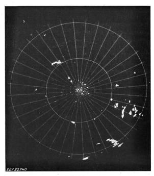
Fig. 10 Ausschnitt aus Fig. 9 mit Standzeichen-Unterdrückung
