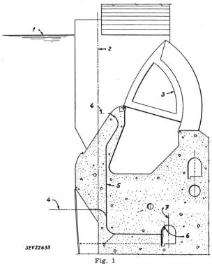
Druckluftverteilanlage für ein Stauwehr mit Sektorschützen 1 höchster Oberwasserspiegel; 2 Stauwehrachse; 3 Sektorschütze; 4 Luftaustrittsdüse; 5 Verteilleitung; 6 Hauptleitung; 7 Kontrollgang.
