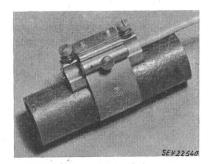
destiné à être serré contre le tuyau par deux boulons. L'alésage est prévu pour un conducteur massif ou câblé de 16 mm<sup>2</sup> de section. Bornes de raccordement assurées par des contre-écrous.
