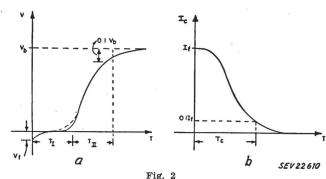
Schaltzeiten in (a) Diode und (b) Transistor Bezeichnungen siehe im Text
