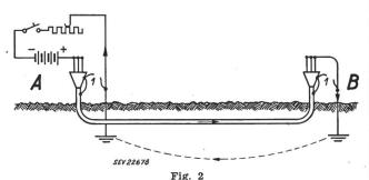
Schéma d'un câble parcouru par un courant continu A, B Stations; I mises à terre déconnectées
