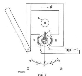
Schéma d'une pince ampèremétrique polarisée, avec source auxiliaire dans le circuit du cadre mobile
