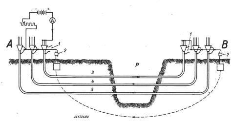
Point 3: Le courant d'essai pour l'identification du câble sera émis sous forme d'impulsions périodiques, par exemple une impulsion de 3 secondes toutes les 15 secondes. Un opérateur se chargera de ce travail à l'extrémité du câble au moment convenu. Si donc, en refermant la pince sur le câble,
