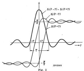
Zusammensetzung eines Impulses der Dauer au aus dem Integralsinus Si  $(t \pm T)$  t Zeit; T konstanter Zeitwert; au Impulsdauer
