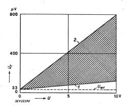
Fig. 1 Störspannungen von 0,5-W-Widerständen, 1  $M\Omega,$  in Abhängigkeit von der angelegten Gleichspannung
