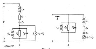
Fig. 1 Messchaltung mit einem Serie- und einem Parallelresonanzkreis
