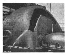
Fig. 1 Infolge unsachgemässer Reinigung explodierte Dampfturbine
