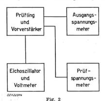
Blockschema der Apparatur zum Messen der Rauschspannung von gleichstromdurchflossenen Schicht- und Massewiderständen
