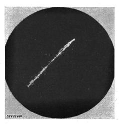
Fig. 1 Nach dem hier geschilderten Verfahren sichtbar gemachter Haarriss in einem Stanzwerkzeug (Vergrösserung vierfach)
