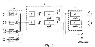
Prinzipschaltbild einer Zweikanal-Übertragungsanlage a Zweikanal-Misch-Vorverstärker; b Kontrollpult; c Zweikanal-Überwachungsverstärker
