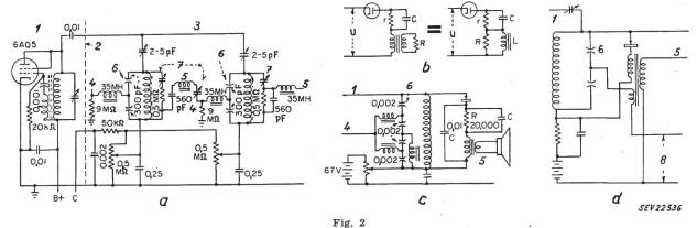
Beispiele von dielektrischen Spannungs- und Leistungsverstärkern
