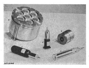
Fig. 3 Ausführungsformen von Ionisationskammern und Zählrohren (Friesecke und Hoepfner)
