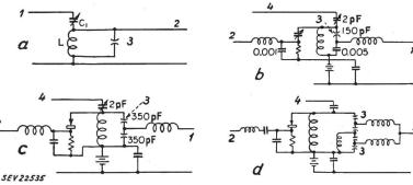
Als nächstes wurde der zweistufige Verstärker von Fig. 2a aufgebaut. Die grösste Verstärkung wurde bei ca. 60 V Vorspannung und effektiv 40 V Trägerfrequenz erzielt. Darauf wurde eine Ausgangsstufe konstruiert, welche einen Lautspre-
