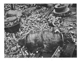
Fig. 9 L'enroulement d'un transformateur de mesure de tension dans l'huile de 125 kV après l'accident de la fig. 8
