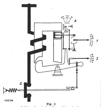
Schéma de principe d'un relais primaire dispositif de déclenchement instantané;
