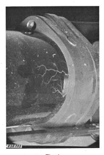
Fig. 1 Formation de chemins de décharge glissante sur un isolateur en papier comprimé
