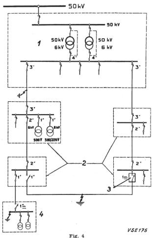
Exemple d'un échelonnement de temporisation lors de l'emploi de relais primaires à maximum de courant (Réseau à 6 kV)
