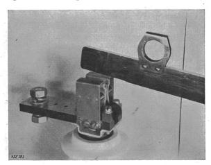
Fig. 11 Contact de sectionneur moderne Fractionné en plusieurs lamelles argentées, pression par ressorts à boudins.
