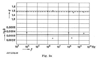
Angle de pertes diélectriques  $tg \delta$  et constante diélectrique  $\varepsilon$  du polyéthylène cellulaire en fonction de la frequence f
