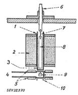
Fig. 1 Querschnitt durch die magnetische Lagerung eines Rotors mit ·Spiegelflächen
