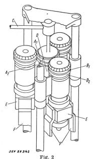
Ausführungsskizze eines Drehstrom-Rollstromrichters in Aussenrollenbauweise
