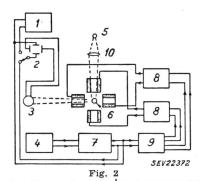
Schema des Motorantriebes und der Drehzahlmessung 1 Tonfrequenz-Oszillator; 2 Kathodenstrahl-Oszillograph; 3 Photozelle mit Vervielfacher; 4 Oszillator; 5 Lichtquelle; 6 Rotor; 7 Frequenzteiler; 8 Kraftverstärker; 9 Phasenschieber; 10 Linse
