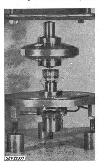
Fig. 3 Ultrazentrifuge mit magnetischer Aufhängung Die Fühlerspule für die Höhenregulierung liegt direkt unter dem Rotor
