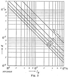
Kritische Frequenz (Grenzfrequenz)  $f_G$  in Abhängigkeit von der Wandstärke d und longitudinaler Schallgeschwindigkeit
