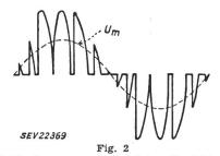
Ungesiebte Spannung an der Sekundärwicklung des Ausgangstransformators  $U_m$  Mittelwert nach Filterung durch Kondensator 11 in Fig 1
