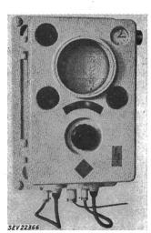
sere Ortungsmöglichkeiten. Demgegenüber ist aber die Reichweite begrenzt, weil die Schallabsorption im Wasser mit der Frequenz zunimmt. Als Kompromiss zwischen erwünschter Bündelung und Reichweite hat sich die Frequenz 30 kHz durchgesetzt. Die Zahl der Schallimpulse in der Zeiteinheit richtet sich nach der gewünschten Lottiefe, also nach dem Messbereich (z. B. 78/min).
