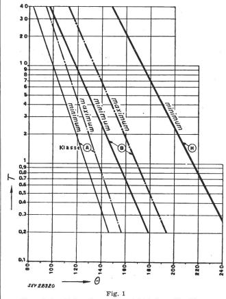
«Thermische» Lebensdauer von elektrischen Maschinen Lebensdauer in Jahren; @ mittlere Wicklungstemperatur in °C
