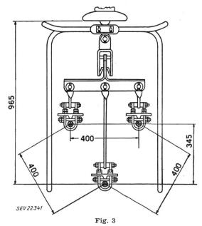
Schutzring und Leiteranordnung einer russischen 400/420-kV-Dreibündelleitung (Masse in mm)
