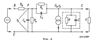
II-Ersatzbild des Junction-Transistors  $G_m v_e$  Einströmung;  $v_e$  Spannung zwischen P und E Weitere Bezeichnungen siehe in Fig. 5
