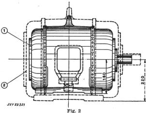
Grössenvergleich zweier Motoren gleicher Leistung in den Isolationsklassen H (1) und A (2) Beim neuen Typ konnte auch der Wellendurchmesser durch Verwendung besseren Stahls verkleinert werden
