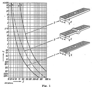
Stromzeitkennlinien von Schmelzeinsätzen mit verschiedenartig geformten Schmelzleitern 1, 2 «flink»; 3 «träge»; t Zeit; I Strom
