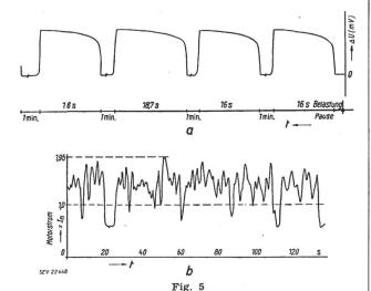
Stossbelastungsprüfung von Schmelzeinsätzen Prüfung eines 60-A-Schmelzeinsatzes in Funktion des Spannungsabfalles
