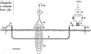
unterschieden werden können, wird der Signalstrom mit einem Taktgeber in einem bestimmten Rhythmus unterbrochen (Morsezeichen). Der Taktgeber wird durch einen kleinen Synchronmotor, oder, wenn man vom Netz unabhängig sein will, durch ein Uhrwerk angetrieben.
