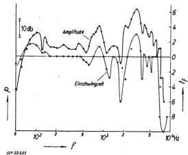
Fig. 1 Amplitudenkurve und Einschwingkurve eines elektrodynamischen Lautsprechers nach Helmbold p Schalldruck; f Frequenz;  $t_f$  Einschwingzeit in Periodenzahl
