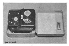
le blocage de jour ou de nuit, ainsi que pour l'enclenchement et le déclenchement périodiques d'un interrupteur unipolaire à contacts en argent, qui sert à la manœuvre du moteur de la soufflante de l'installation de chauffage. L'automate peut-être mis hors circuit à l'aide d'un interrupteur incorporé à bascule. Un petit fusible est inséré dans le circuit secondaire. Le boîtier en tôle est muni d'une vis de mise à la terre.
