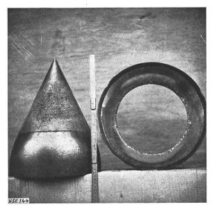
Fig. 1 Erosion des pointeaux et tuyères
