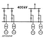
Fig. 3 Prinzipschaltung eines Wasserkraftwerkes mit einem Ausgangsschienensystem
