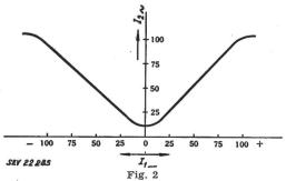
Ubersetzungskurve des einfachen Gleichstromwandlers  $I_1$ — Gleichstromeingang;  $I_2$ — Wechselstromausgang
