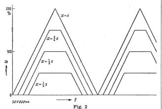
Der mathematisch berechnete Schwingungsvorgang für eine Wicklungsanordnung gemäss Fig. 1 nnung; t Zeit; x Wegkoordinate längs der Wicklung; s totale Leiterlänge der Oberspannungswicklung
