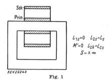
Schematisches Bild der beiden Spulen eines Transformators mit Zylinderwicklung
