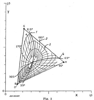
Lage der Achsen der Farbdifferenzsignale im Farbdreieck 1 Q-Signalachse; 2 Phase des Farbhilfsträgers; 3 Amplitude des Farbhilfsträgers; 4 I-Signalachse B Blaupunkt; C Graupunkt; G Grünpunkt; R Rotpunkt
