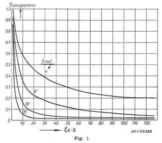
Gradationskurven in Abhängigkeit von der Belichtung bei verschiedenen Belichtungszeiten
