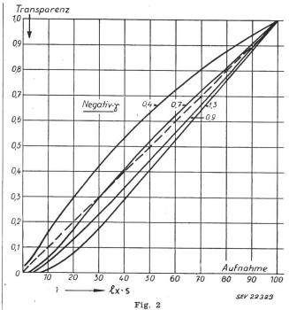
Transparenz der Kopie in Abhängigkeit von der Negativbelichtung bei verschiedenen Gradationswerten des Negativs
