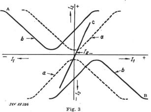
Verschiebung der Übersetzungskurve durch Vormagnetisierung a ohne Vormagnetisierung; b mit Vormagnetisierung; c resultierende Übersetzungskurve;  $I_1$  Eingang;  $I_2$  Ausgang;  $I_2$  Gleichstromausgang
