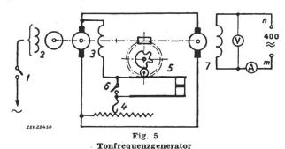
1 Motorschalter; 2 Antriebsmotor (umschaltbar); 3 Erregermaschine; 4 Regelwiderstand; 5 automatischer Unterbrecher; 6 Überbrückungsschalter; 7 Generator
