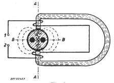
Fig. 2 Kraftlinjenverteilung von Bleikabeln ohne Armierung bei angelegtem Elektromagnet -A, B-B Achsen des Wechselfeldes; 1,2 Kopfhöreranschluss
