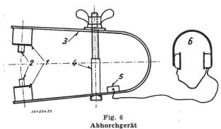
1 Elektromagnete; 2 freie Elektromagnetpole; 3 Rückschlusseisen; 4 Stellschraube; 5 Verbindungsdose; 6 Kopfhörer
