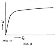
Leerlaufmagnetisierungskurve eines Stromwandlers U Spannung am offenen Wandler;  $I_{\theta}$  Magnetisierungsstrom
