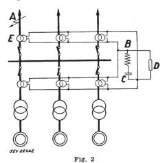
Sammelschienenschutz mit Spannungsdifferential-Relais
