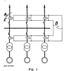
Sammelschienenschutz mit Stromdifferential-Relais A «Aussen» liegende Kurzschlußstelle; B Stromdifferential-Relais; E Übersättigter Wandler
