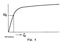
Leerlaufmagnetisierungskurve eines Stromwandlers  $I_{\sigma}$  Erregerstrom;  $U_{\sigma}$  am Spannungsdifferential-Relais eingestellte Ansprechspannung
