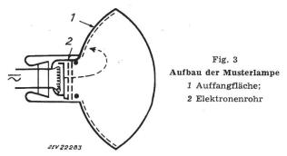
Kathode ist indirekt beheizt und der Heizdraht so bemessen. dass er direkt an Netzspannungen von 110 bzw. 220 V angeschlossen werden darf. Die Kathode braucht nicht so viele
