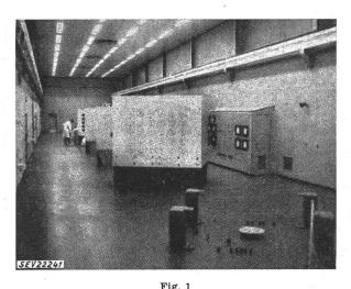
Vier Untersuchungskästen für hochaktive Metallstücke Die Proben werden durch Kanäle in die abgeschirmten Innenräume eingeführt und dort durch von aussen bediente Apparaturen bearbeitet und gemessen
