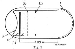
Schematischer Aufbau einer selbststabilisierenden Lampe  ${\it I}$  Auffangfläche  ${\it F}$  Heizdraht der Kathode; C Kathode;  ${\it G}_1,~{\it G}_2$  Gitter;  ${\it E}_3$  Elektrode
