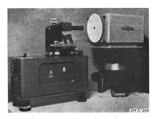
Fig. 2 Fernsehmikroskop
