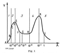
Strom-Spannungscharakteristik einer Entladung 1unselbständige Entladung; 2halbselbständige Entladung; 3normale Entladung; 4anomale Entladung; 5Bogenentladung
