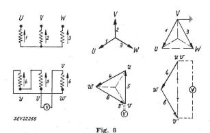
Vektordiagramme bei gesundem und erdschlussbehaftetem Netzbetrieb
