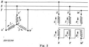
Räumliches Wicklungsbild der Ober- und Unterspannungswicklungen eines Drehstromtransformators mit speisendem Generator
