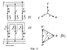
Schaltgruppe eines Transformators mit der Wicklungs-schaltung Yd5 (C2), bei vertauschten Anschlüssen S. T.; r, s, t Pole des Drehstromsystems
