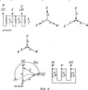
Ermitteln der räumlichen Wicklungsschaltung aus einer Schaltgruppe Yd7, wenn die Oberspannungsanschlüsse um 180° gedreht werden
