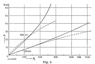
Winkel  $\Im$  zwischen Anfangs- und Endspannung in Funktion der abgegebenen Wirkleistung  $P_e$  bei  $\cos \varphi_e = 1$  für Leitungen mit Querkompensation
