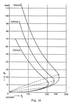
Winkel  $\Im$  zwischen Anfangs- und Endspannung in Funktion der abgegebenen Wirkleistung  $P_e$  bei  $\cos \varphi_e = 1$  für Leitungen mit Längskompensation
