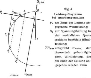
den soll. In Fig. 4 entspricht sie der Strecke  $\overline{OC}_{max}$  und beträgt für Drehstrom
