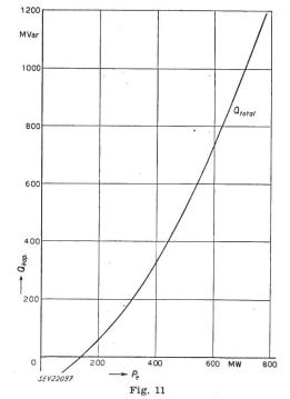
Erforderliche Kompensationsblindleistung Q in Funktion der abgegebenen Wirkleistung  $P_e$  bei  $\cos\varphi_e=1$  für eine Fernleitung mit Quer- und Längskompensation
