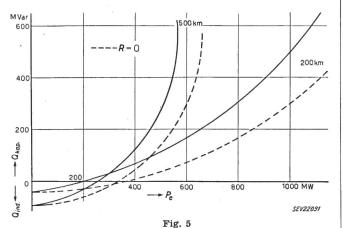
Erforderliche Kompensationsblindleistung  $Q_q$  in Funktion der abgegebenen Wirkleistung  $P_e$  bei  $\cos \varphi_e = 1$  für Leitungen mit Querkompensation
