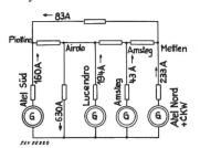
Fig. 2 Stromverteilung im Mitsystem
