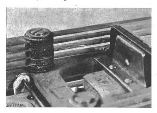
Fig. 12 Linienrelais mit Lichtbogenspuren
