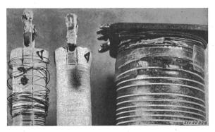
Fig. 11 Zerstörte Widerstände und Wicklungen
