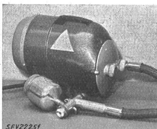
tanément deux pistolets à peinture. Cordon de raccordement renforcé, fixé au moteur. Les pistolets à peinture sont isolés de la carcasse de l'appareil. La poignée est également isolée.
