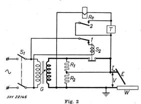
Vereinfachtes Schema der Schutzeinrichtung G Schweisstransformator; W geerdetes Werkstück; E trode;  $R_1$ ,  $R_2$  Spannungsteiler;  $S_1$  Netzschalter;  $S_2$  Sc $R_2$  Relais mit Ruhekontakt I und Arbeitskontakt I; I zögerungseinrichtung
