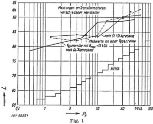
Vergleich von berechneten und gemessenen Werten der Schallpegel des Grundtones L an der Oberfläche von Transformatoren abhängig von der Typenleistung  $P_t$
