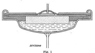
Schnitt durch einen gesinterten Tantal-Elektrolytkondensator
