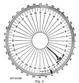
Verlauf des Lastwinkels des Kompensators bei plötzlicher Zuschaltung des Verbrauchers im Schema nach Fig. 8
