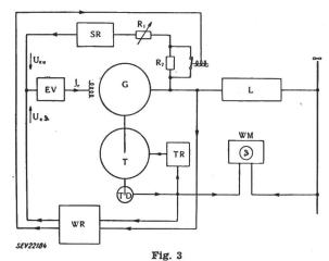
Prinzipschaltung eines Generators mit winkelabhängiger Regulierung
