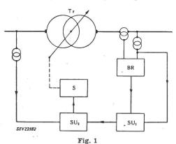
Prinzipschema der Blindleistungsregulierung an Kuppeltransformatoren
