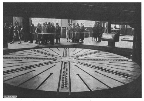
Fig. 1 Die Planscheibe der Karusselldrehbank
