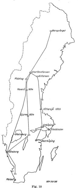
Karte des schwedischen 380-kV-Netzes mit Standorten der bisher angeführten und bis 1956 zur Ausführung gelangenden Kondensatorstationen
