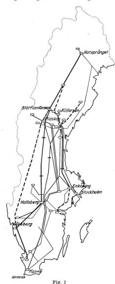
Gegenwärtige Ausbreitung des 380-, 220- und 130-kV-Netzes mit den geplanten Ergänzungen
