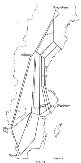
Geplanter Endausbau des schwedischen 380-kV-Netzes
