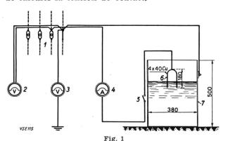
Schéma électrique du dispositif de mesure
