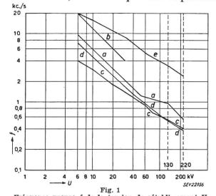
Fréquence propre f de la tension de rétablissement U correspondant à des propositions différentes a Johansen, CIGRE 1952, rapport N° 104, pour des puissances de rupture de 500 MVA et plus; b idem, pour des puissances de rupture plus petites que 500 MVA; c Règles suisses, publication N° 186 de l'ASE, Avril 1953; d Règles françaises, publication de l'Union technique de l'Electricité; n° C 64—100, Février 1951; e Propositions anglaises, CIGRE 1948, rapport N° 138
