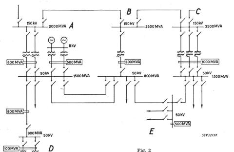
Exemple de l'enquête concernant les disjoncteurs dans des réseaux à 50 kV
