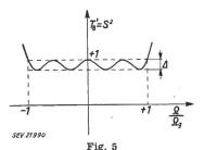
Verlauf der Spannungsübersetzung eines vierkreisigen Filters $T_8{}'=S^2=\mathbf{f}\left(rac{\Omega}{\Omega_g}
