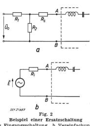
Beispiel einer Ersatzschaltung a Eingangsschaltung b Vereinfachung  $R_1$ ,  $R_2$ ,  $R_3$  Ohmsche Widerstände  $\overline{E} = \frac{R_2}{R_1 + R_2} \cdot \overline{U}_0$   $R_i = R_s + \frac{R_1 R_2}{R_1 + R_2}$
