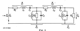
Ersatzschema einer vierkreisigen Filterschaltung
