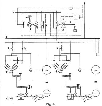
Réglage puissance-fréquence à l'usine de Loentsch
