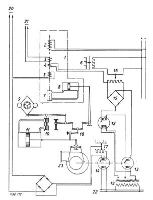
Cet organe est actionné par un électro-aimant à quatre enroulements jouant le rôle de récepteur.
