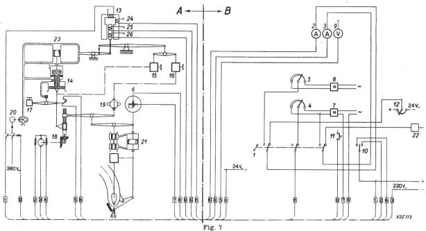
Réglage puissance-fréquence à l'usine d'Innertkirchen A Centrale B Local de commande
