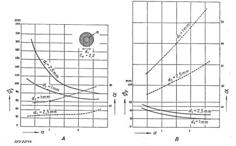
dar. Er hat einen wirksamen Felddurchmesser von 11 cm und eine Dämpfung von 6 db/100 m. Ein gutes Koaxialkabel hätte bei dieser Frequenz ca. 60 db/100 m, und ein rechteckiger Hohlwellenleiter aus Messing mehr als 5 db/100 m. Qualitativ ist also dieser Drahtwellenleiter dem Rechteckförmigen gleichwertig. Bei 9700 MHz ist der Draht 2,5/3,5 sogar dem rechteckigen Wellenleiter aus Kupfer ebenbürtig.
