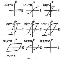
Fig. 4 Dielektrische Hysterese an Kaliumphosphat bei verschiedenen Temperaturen (nach Busch und Ganz)
