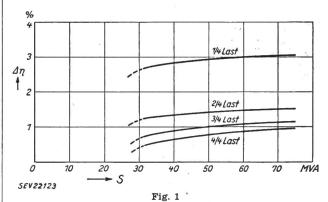
Wirkungsgradverbesserung  $\Delta\eta$  für Wasserstoffkühlung gegenüber Luftkühlung in Abhängigkeit der Scheinleistung S bei  $\cos\varphi=0.8$  für Vollast und Teillasten
