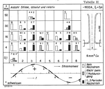
spannung keinen Nachstrom zur Folge haben, während bei solchen im positiven oder negativen Scheitelwert, bis zu 30 mm Schlagweite, immer ein Nachstrom von 1...6 Halbperioden Dauer fliesst. Der Lichtbogen wandert dabei infolge der Selbstblasung nach oben, wird verlängert und reisst ab, bevor er abgeschaltet wird. An den Elektroden entstehen nur
