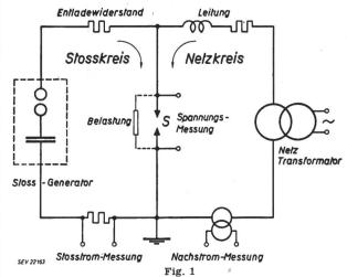
Prinzipschema der Versuchsanlage S zu untersuchende Lichtbogenstrecke
