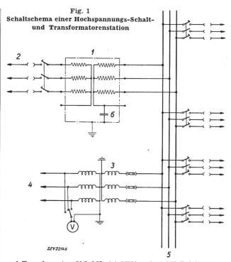
1 Transformator 50/9 kV, 6,4 MVA; 2 50-kV-Zuleitung; 3 Spannungswandler als Erdungsdrosselspulen geschaltet; 4 zu den übrigen Messinstrumenten; 5 9-kV-Sammelschiene; 6 konzentriert angenommene Kapazität der Unterspannungswicklung gegen den geerdeten Transformatorkessel
